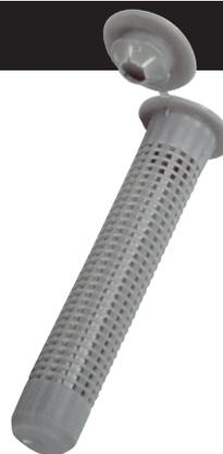
Blister de 5 tamices de 13x85 mm para aplicación de taco químico en ladrillo o piedra hueca. Adecuado para varillas roscadas de 8 mm y 10 mm.
