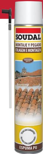
Espuma de poliuretano adhesiva de baja expansión para el pegado rápido de tejas sobre soportes como hormigón, ladrillos, metal, madera, chapas de aislamiento, PVC (excepto PE, PP y Teflon®). No expande, por lo que una vez fijados los materiales, permanecen en su lugar. Resiste al hielo, al calor y a las acciones del viento. No resiste los rayos UV, es recomendable protegerla pintándola. Está disponible en color gris o terracota para lograr un resultado estético óptimo.
