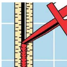
Depois da preparação adequada da junta e do substrato, introduza o delimitador na profundidade requerida. Introduza na pistola o selante e aplique firmemente o SILICONE MULTIUSO dentro da junta, garantindo um contato total com as bordas da junta.
